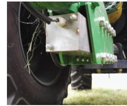
Der Sensor registriert Zug- und Schubkräfte, damit das System automatisch zwischen Antreiben und Bremsen wechseln kann.
