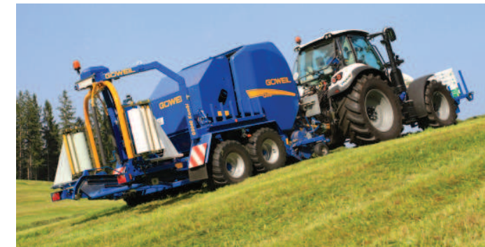
Besonders in steilem Gelände bringen Anhänger-Triebachsen viele Vorteile. Sie sorgen für Fahrstabilität und damit auch für mehr Sicherheit.
