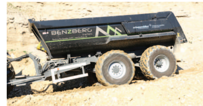
Auch unter feuchten Bedingungen und vor Hindernissen blockiert die Triebachse nicht. (Bilder: Paul Forrer AG, Colsman)
