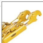
TU-310 WKS – Dreipunkt- Schnellkuppler und Oberlenker
