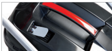
Die Füllstand-Anzeige signalisiert, wenn der Sack geleert werden muss, so dass weniger Zwischenstopps zur Überprüfung des Füllstands erforderlich sind und kein Gras durch Überfüllung verschüttet wird.
