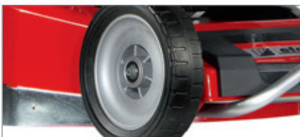
Roues en aluminium : elles garantissent une résistance excellente pour les opérations en conditions sévères.
