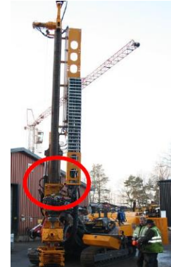
Foreuse changement de la tête de forage
