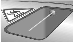
Als zusätzliche Sicherheit gegen Überhitzen der Brennkammer befindet sich im Kamin ein Temperaturfühler. Dieser schaltet den Brennermotor, den Zündtrafo und das Magnetventil ab, sobald die Abgastemperatur 250 °C übersteigt.
