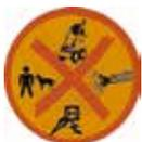
L'utilisation inadéquate d'un jet haute pression peut être dangereuse. Ne jamais diriger le jet sur une personne, sur un animal, sur un équipement électrique actif ou sur le nettoyeur (voir pages 8).
