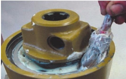
Dichtring einlegen und in Nut des Kupplungsgehäuses drücken.
