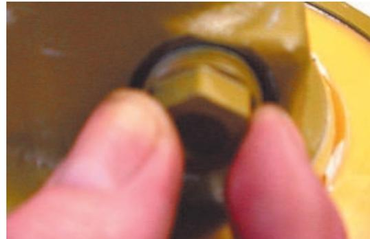
Dichtring mit Schraubenzieher an markierter Stelle anheben und herausnehmen.
