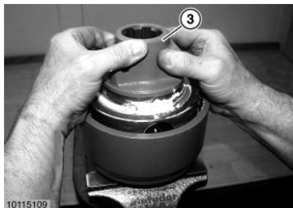
Komplett bestückte Nabe (3) ins Kupplungsgehäuse einsetzen.
