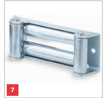
Rollenseilfenster reduzieren den Seilverschleiss bei schrägem Zug. (Nicht für Kunststoffseile)
