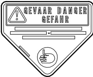
Gefahr von Verletzungen der Hände. Hände oder Füße dürfen niemals unter die Maschine geraten, wenn die Messer nicht zum Stillstand gekommen sind. Der Motor muss bei Unregelmäßigkeiten immer ausgeschaltet werden. Dies gilt insbesondere bei der Durchführung von Wartungsarbeiten.
