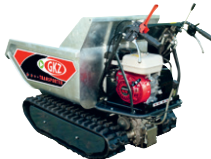
GK 500 D Ausführung mit hydraulischer Kipp-Mulde
