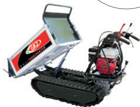
GK 500 HEI Ausführung mit hydraulischer Brücke
