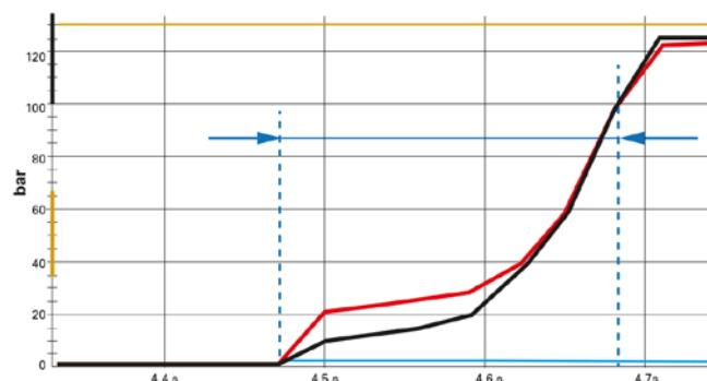
Druckaufbau am Bremszylinder **ohne Relais-Ventil**
