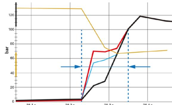
**Mit Relaisventil** = Zeitgewinn ca. 200% bei gleichem Testaufbau. t = 0,22 Sekunden von 0 auf 100 bar
