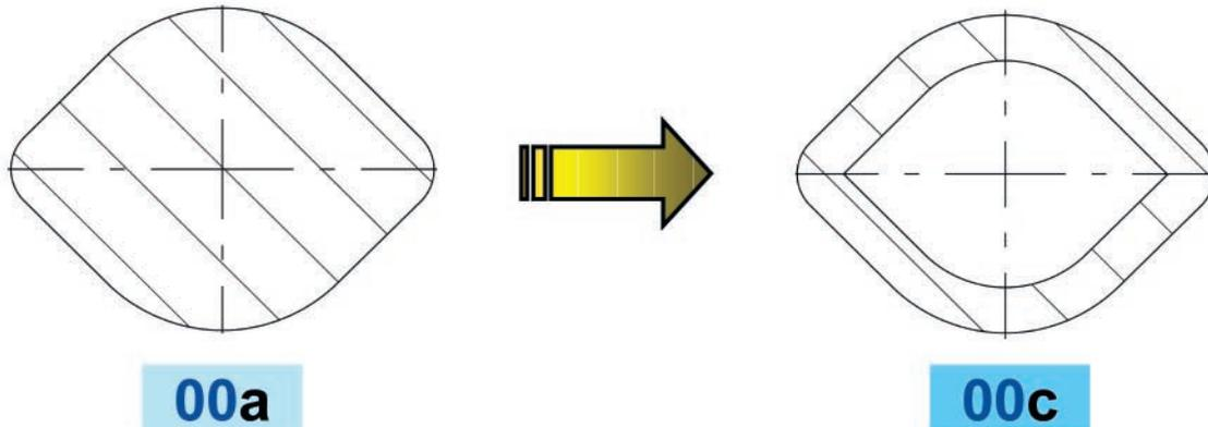
Das Schiebeprofil 00a wird zukünftig durch das Profilrohr 00c ersetzt.
