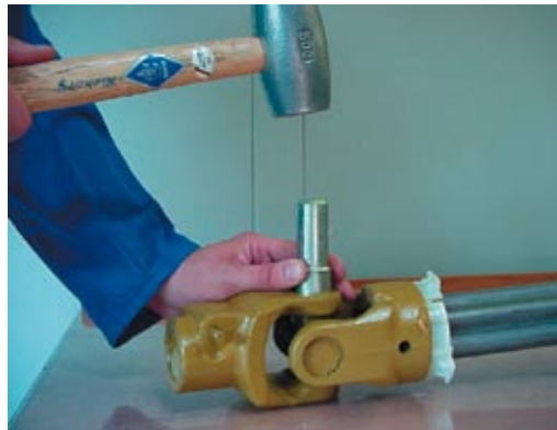
Sicherungsring durch Hammerschläge auf Austreiber (SW28) entspannen.
