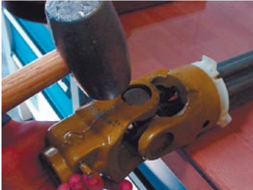
Gelenk durch Hammerschläge auf die Gabelschenkel entspannen.
