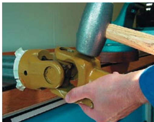
Gelenk auflegen und Lagerbüchse durch leichte Hammerschläge hochtreiben.
