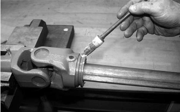
Laufrihle der Gabel und Innenprofilrohr einfetten.
