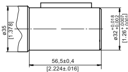
C - ø32 straight, Parallel key A10x8x45 DIN 6885 Max. Torque 77 daNm [6815 lb-in]
