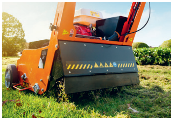
Le rouleau en caoutchouc est entraîné ; il a un diamètre de 15 cm. Il entraîne aplanit le sol, roule la surface pour la rendre lisse et la prépare ainsi de manière optimale pour la saison de tonte qui commence. Le guidon de direction amortit les vibrations. Il absorbe presque toutes les vibrations grâce à sa suspension.
