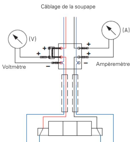
Il est important de commencer le réglage avec la valeur de courant minimale et de continuer avec la valeur maximale. Au final, il faut contrôler le réglage du fait que les deux valeurs peuvent s'influencer mutuellement. Si ce n'est pas possible, c'est la valeur supérieure qui doit être réglée en priorité du fait que celle-ci doit toujours être plus élevée que la valeur inférieure.
