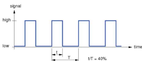
L'interrupteur peut rester enclenché du temps zéro jusqu'à la durée de la période entière. Plus le temps durant lequel l'interrupteur est sur «On» est élevé, (40% sur la figure), plus le niveau de tension grandit. Avec une résistance de bobine magnétique constante, le courant devient plus fort et par conséquent la force de l'aimant aussi. Le passage de la soupape augmente ou dans le cas d'une soupape de pression la pression augmente.
