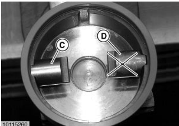
C Richtige Einbaulage des Sperrnockens D Falsche Einbaulage des Sperrnockens
