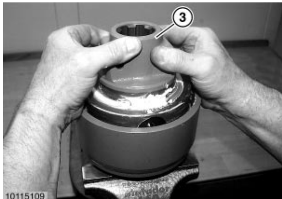
Komplett bestückte Nabe (3) ins Kupplungsgehäuse einsetzen.
